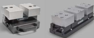
Der gekapselte DATRON Kompaktzentrispanner ist 100 % gegen Verschmutzung geschützt. Durch seine speziell entwickelte Schiebergeometrie mit Führungslänge 150 mm ist der KZS der erste vollständig gekapselte Zentrispanner. Funktionsstörungen durch Verschmutzung und eingeklemmte Späne gehören damit der Vergangenheit an.
