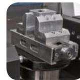
**5-Achs-Fräsen mit Dreh-Schwenktisch** für die präzise Mehrseitenbearbeitung von Kleinteilen (optional).
