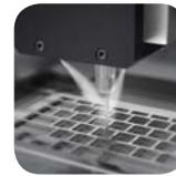
**Ressourcensparend:** Minimalmengen-Kühlschmierung ab 30 ml/h. Geringster Reinigungsaufwand (optional).
