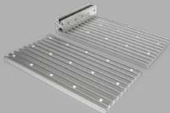
Die T-Nuten-Modulspannplatte bietet Platz für anwendungsspezifische Befestigungslösungen oder die Kombination aus Kurzhubspannelement und fester Spannbacke. Befestigt werden die Module auf dem Maschinentisch wahlweise per Verschraubung oder über das Vakuum-Ansaugsystem.
