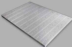
Die DATRON Mäanderplatte eignet sich besonders zum Spannen flächiger Werkstücke und Plattenmaterialien. Dabei können mehrere gleichartige oder auch verschiedene Werkstücke aufgespannt werden. Der DATRON Spezialkarton VacuCard™ dient zur Verteilung des Vakuums unter dem Werkstück und als Opferschicht. Die Mäanderplatten sind in verschiedenen Größen erhältlich.
