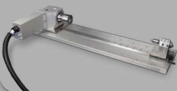
Die Drehachse eignet sich besonders zur Mehrseitenbearbeitung von langen Werkstücken, für Rundgravuren oder zum Bohren in radialer Richtung. Die Befestigung erfolgt über DATRON Modulspanntechnik, wodurch eine variable Spannlänge gegeben ist. Die Drehachse ist anschlagnfrei und bietet hohe Präzision und Verdrehsteifigkeit.
